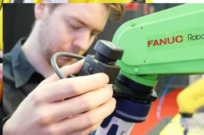
Kris Jansen bij de nieuwe collaboratieve robot en de joystick op de cobotarm (zie inzet).
